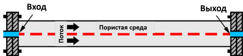
Рисунок 28 – Схематическое представление области используемой в 1D моделировании
